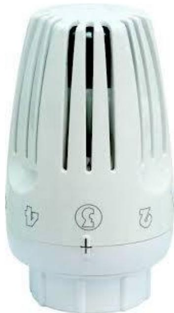
Variation temporelle certifiée CERTITA (0,3 K). Installable sur toutes les robinets thermostatizable série VT. Plage de températures en combinaison avec le robinet : 5÷110 °C. Pression maximale d'exercice en combinaison avec les robinets : 10 bar. Pression différentielle maximale : 1,4 bar (1/2?). Position du blocage mécanique (shut-off) : complètement fermé en position ?0?.
