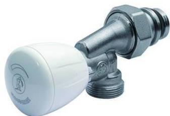
Série "FER". Double réglage micrométrique. Douille auto-étanche. Température : 5-110 °C. Pression max de service : 16 bars. Composition : corps, écrou et douille en laiton, volant en ABS. À compléter avec adaptateur R178 pour tube cuivre, R179 pour tube plastique, ou R175 AM pour les tubes multicouches. Livré avec capuchon de protection.
