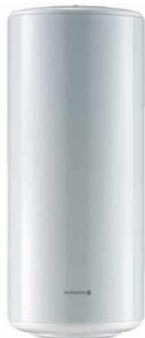
Idéal pour un foyer de 6 à 7 personnes. Accumulation avec anode magnésium. Résistance électrique blindée. Thermostat réglable. Isolation en mousse de polyuréthane injectée (0%CFC). Habillage en tôle d'acier laquée blanc.
