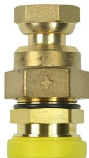
Raccords d'extrémités FLEXICLIC à joint plat gaz. Tuyau FLEXIPIPE annelé en acier inoxydable. Pression maximale d'utilisation du calibre 10 au calibre 25 : 2 bar. Pression maximale d'utilisation du calibre 32 au calibre 50 : 500 mbar.
