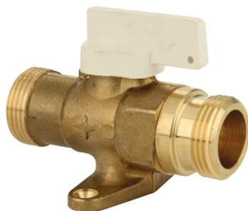
Pression maximale d'utilisation : 500 mbar. Robinet double mâle à Joint Plat Gaz. Classe de température : - 5°C / + 60°C. Certifié NF ROB GAZ. Conforme NF EN 331.
