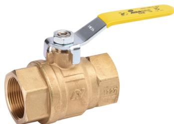
Vanne à sphère laiton NF ROB-GAZ à passage intégral pour le sectionnement de réseaux gaz. Vanne certifiée par Certigaz. L'étanchéité est assurée par 2 joints toriques NBR à l'axe et des sièges PTFE.
