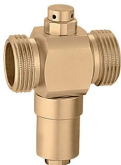
Corps laiton. Température d'ouverture : eau à +3°C. Température de fermeture : eau à +4°C (+/- 1°C). Pression maxi : 10 bar. Cartouche thermostatique et clapet anti-vide.
