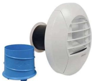
Bouche d'extraction pour la salle de bains. 1 débit. Régulation débit permanent suivant humidité de l'air. Piquages Twist & Go Ø 80 mm. Débit maxi : 40 m<sup>3</sup>/h. Plage de débit : 10-40 m<sup>3</sup>/h. Modèle : BHB 10/40 SDB.
