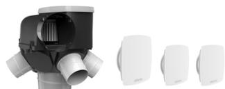
VMC simple flux autoréglable intelligente pour logement individuel. Idéal en remplacement grâce à ses bouches Line à raccord universel. Jusqu'à 6 sanitaires + 1 cuisine. Groupe en polypropylène recyclable : 6 piquages Twist &, Go Ø 80, 1 piquage Twist &, Go Ø 125, rejet Ø 125. Moteur AC. Microprocesseur + 2 doubles capteurs capacitifs.
