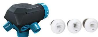
Raccordement possible jusqu'à 6 sanitaires. Le kit comprend 3 bouches Hygro : une en diamètre 125 pour cuisine (pile), une en diamètre 80 avec détection de présence pour les WC (pile) et une en diamètre 80 pour salle de bains. Piquages dotés du système Twist & Go, fixation rapide et étanche des gaines.
