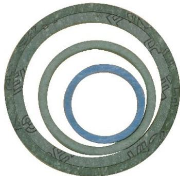
Pression maximale d'utilisation : 500 mbar. Joint en fibre synthétique (aramide) livré systématiquement avec nos raccords à Joint Plat Compteur. Classe de température : -20°C / +60°C. Conforme NF E 29533.
