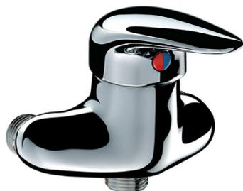
Mitigeur de douche universel à cartouche céramique. Corps en laiton chromé. M1/2". Entraxe réglable de 60 à 80 mm. S'adapte à l'entraxe existant. Garantie 10 ans. Permet le remplacement d'un ancien mélangeur par échange standard, sans modification de l'installation.
