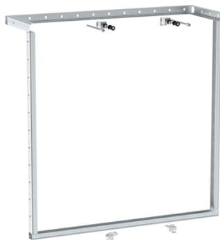
Pour paroi en applique à hauteur partielle. Contenu : 2 rails système de longueur 1 m, 2 rails système de longueur 1,15 m, rail système de longueur 0,7 m, bandes isolantes et de séparation de 5 m de long, 10 vis à bois, 10 chevilles, 2 fixations murales, kit de rallonge pour fixation murale.
