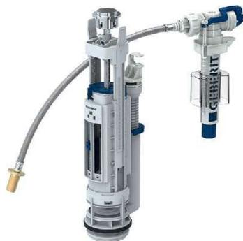
S'adapte à tout type de réservoirs céramique. Hauteur de remplissage réglable. Adaptable en hauteur. Tube de trop-plein réglable en hauteur. Robinet flotteur Impuls290. Remplissage rapide et silencieux. Arrivée d'eau latérale. Arrivée par le bas. Raccordement standard : embout laiton 3/8" (12/17). Avec fixation du couvercle.
