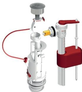
Soupape à câble double touche à économie d'eau, conçue pour un montage rapide sans découpe du trop-plein, fournie avec bouton double touche chromé pour trous de couvercle de 18, 40 ou 50 mm, offrant une hauteur ajustable de 310 à 450 mm, réglage de la demi-chasse et du résiduel, livrée complète avec joints d'étanchéité, kit de fixation de la cuvette, bouton de commande et rondelles d'adaptation.
