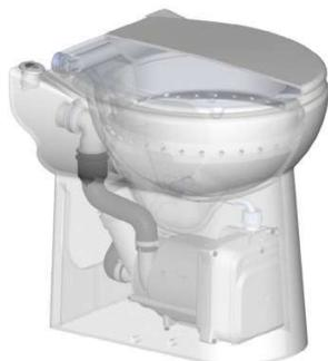
Idéal pour réaménager les espaces les plus réduits. Possibilité de raccorder un lave mains. Silencieux. Système Eco+ (double chasse 1,8/3 litres). Diamètre de refoulement conseillé : 32 mm. Température moyenne des eaux usées entrantes : 35°C. Alimentation : 220-240V/50Hz. Clapet anti-retour fourni. Evacuation de vos eaux usées et vanes jusqu'à 3 mètres verticalement ou 30 mètres horizontalement. Débit : > 100 litres/min. Fixation au sol fournies.
