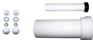
Manchon d'évacuation droit longueur 285 mm, diamètre 100 mm, en PVC, joint en EPDM. Manchon d'alimentation droit longueur 239 mm, diamètre 45 mm, en PEHD, avec butée pour joint, joint à lèvres en élastomère pour Ø 55 mm. Kit de fixation cuvette rapide avec écrous et caches.
