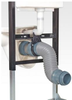
Raccordement sur céramique  $\varnothing$  102 mm  $\pm$  5 mm, tout collier de bâti-support et canalisation  $\varnothing$  100 et 110 mm. Monter le manchon supérieur de la pipe dans le collier du bâti-support et emboîter le manchon inférieur dans l'attente d'évacuation.
