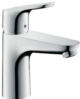
Mitigeur de lavabo 100 CH3 CoolStart, avec tirette et vidage chromé comprenant : mitigeur de lavabo, garniture de vidage. ComfortZone 100. Type de jet : jet normal. Débit maximal sous 3 bars de pression : 5 l/min. Cartouche céramique. Limiteur de température réglable. Convient au chauffe-eau instantané. Garniture de vidage 1"1/4. Matériau de la garniture de vidage : métallique. E00, CH3, A3, U3. CoolStart : démarrage en eau froide en position de poignée centrée.
