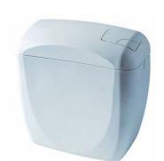
Réservoir attenant à commande double touche sur le dessus par palette, garantie 10 ans. Hauteur 410 mm, largeur 430 mm, profondeur 150 mm. Réservoir isolé réglé à 3/6 litres, aspect céramique de capacité maximale 9l, équipé d?un mécanisme double volume et d?un robinet flotteur silencieux NF, connexion en eau externe 3/8e à droite ou gauche. Livré avec une butée dorsale, un stabilisateur et des accessoires de fixation et de connexion.
