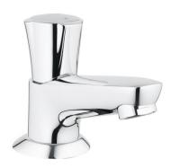
Hauteur totale : 93 mm. Saillie : 80 mm. Hauteur sous bec : 39 mm. Marquage bleu. Tête Carbodur. Bec coulé avec mousseur. Ecrou de raccord 1/2 à taraudage 10.5 mm.
