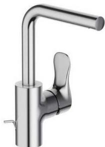
Cartouche à disques céramique. Raccords: Avec flexibles d'alimentation. Normes ACS. Débit: 5 l/mn. Saillie du bec: 248 mm. Fixation rapide 5/35".
