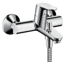
Mitigeur bain/douche C2 avec cartouche à 2 vitesses chromé. Longueur 172 mm - 179,5 mm. 2 sorties = 2 fonctions. Type de raccordement: raccords S. Entraxe: 150 mm ± 12 mm. Type de jet du mitigeur: jet normal. Débit maximal sous 3 bars de pression: 22 l/min. Cartouche céramique à 2 vitesses. Limiteur de température réglable. Inverseur avec réinitialisation automatique. Sécurité contre le retour de l'eau. Avec silencieux. Convient au chauffe-eau instantané. E3/1, C2, A2, U3.
