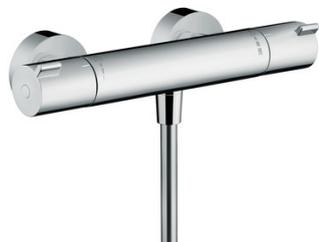
Butée de confort à 40° C. Limiteur de température réglable. Débit du raccordement de la douchette sous 3 bar: 30 l/min. Le bouton Ecostop limite la consommation à 10l/min. Type de raccordement: raccords S.
