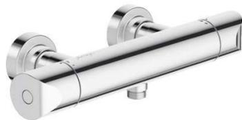
Mitigeur thermostatique de douche. Économie d'eau : Un débit limité à 13l/mn. Confort : Une régulation ultra-rapide pour assurer une eau à température constante et une butée de température à 37°C. Sécurité : Un corps tiède pour éviter tous risques de brûlures. Et un blocage automatique de l'arrivée d'eau au-delà-de 50°C en cas de coupure d'eau froide.
