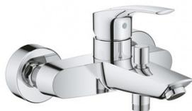
Montage mural apparent. Levier de commande métallique. GROHE SilkMove Cartouche en céramique 35mm avec butée éco 1/2 débit. Limiteur de débit ajustable avec limiteur de température. GROHE StarLight Chrome éclatant et durable. Inverseur automatique pour 2 sorties. Mousseur. Clapet anti-retour intégré. Raccords en S. Rosaces métalliques. Protégé contre les retours d'eau.
