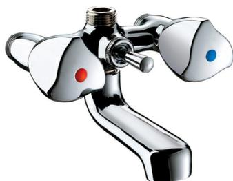
Bec fixe à brise-jet. Croisillons DELTA chromés. Pour "échange-standard". Corps en laiton chromé. M1/2", entraxe 110 mm. S'adapte à l'entraxe existant. Il permet le remplacement d'un ancien mélangeur par échange standard, sans modification de l'installation.
