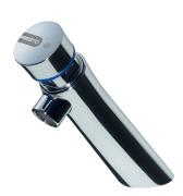
Pression d'utilisation recommandée : 1 à 5 bars. Débit : 3 l/mn à 3 bars, réglage 4 positions, dispositif anti-coup de bélier. Durée d'écoulement : 15 secondes  $\pm$  5 secondes. Alimentation hydraulique : Mâle G 1/2 (15x21).
