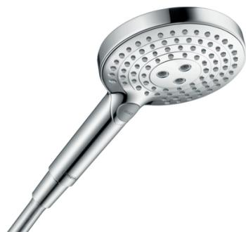
Diamètre : 125 mm. Jet PowderRain, jet Rain, jet WhirlAir. Changement de jet via le bouton Select. Débit sous 3 bars : 12 l/min. Filtre nettoyable. Convient au chauffe-eau instantané.
