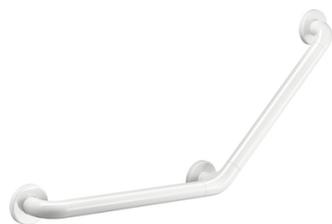
Barre d'appui coudée 135° Ø 32, pour PMR. Nylon HR brillant blanc. Utilisation comme barre d'appui (partie horizontale) ou de relèvement (partie à 135°) pour WC, douche ou baignoire. Utilisation indifféremment à gauche comme à droite.
