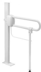
Usage de la béquille recommandé lorsque la paroi de fixation n'est pas solide. La béquille de soutien convient aux barres d'appui relevables Ø 30 mm.
