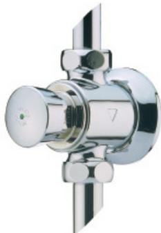
Pression d'utilisation recommandée : 1 à 5 bars. Débit : 30 l/mn à 1 bar. Réglage par bague du débit. Dispositif anti-coup de bélier. Alimentation hydraulique : Alimentation en ligne. Entrée/Sortie mâle G 3/4" (20x27). Les robinets PRESTO 60 et PRESTO 60 B sont livrés en sortie d'usine, bague vissée pour libérer la section maximale de passage d'eau. Livré avec : 1 joint plat et 1 écrou raccord, 1 Ecrou pour tube 16x18, 1 Rosace solidaire du robinet.
