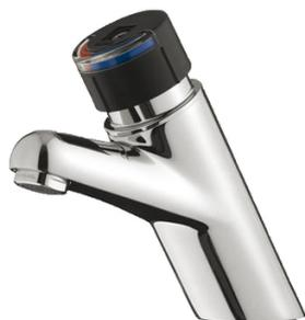
Pression d'utilisation recommandée : 1 à 5 bars. Débit : 3 l/mn avec limiteur de débit intégré, dispositif anti-coup du bélier. Brise-jet : anti-vandalisme et anti-bouchage. Durée d'écoulement : 15 secondes  $\pm$  5 secondes. Alimentation hydraulique : G 3/8" (12x17).
