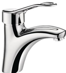
Mitigeur mécanique de lavabo H.85 L.135 avec sortie BIOSAFE hygiénique. Cartouche céramique Ø 40. Butée de température maximale prééglée. Débit limité à 5 l/min à 3 bar. Commande par manette ajourée. Sans tirette ni vidage. Flexibles PEX F3/8". Fixation renforcée par 2 tiges Inox.
