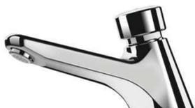
Temporisation ~7 secondes. Débit pré-réglé à 3 L/min à 3 bar, ajustable de 1,5 à 6 L/min. Brise-jet antitartre inviolable. Corps en laiton massif chromé M1/2". Fixation par contre-écrou. Système antiblocage AB : écoulement uniquement lorsque le bouton poussoir est relâché.
