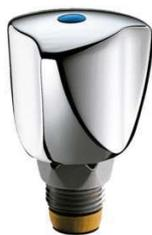
Tête universelle à clapet. Croisillon GAMMA en métal chromé. Remplace les têtes usagées sur la plupart des robinetteries. Tête de rechange à longue durée de vie. Profondeur du siège réglable de 16 à 32 mm. Livrée avec pastilles bleue et rouge.
