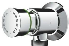
Robinet temporisé. Alimentation en équerre, sans raccord. Débit : 9L/min. Alimentation hydraulique : G 1/2". Durée d'écoulement : 6 secondes (+- 2 secondes). Dispositif anti-coup de bélier.
